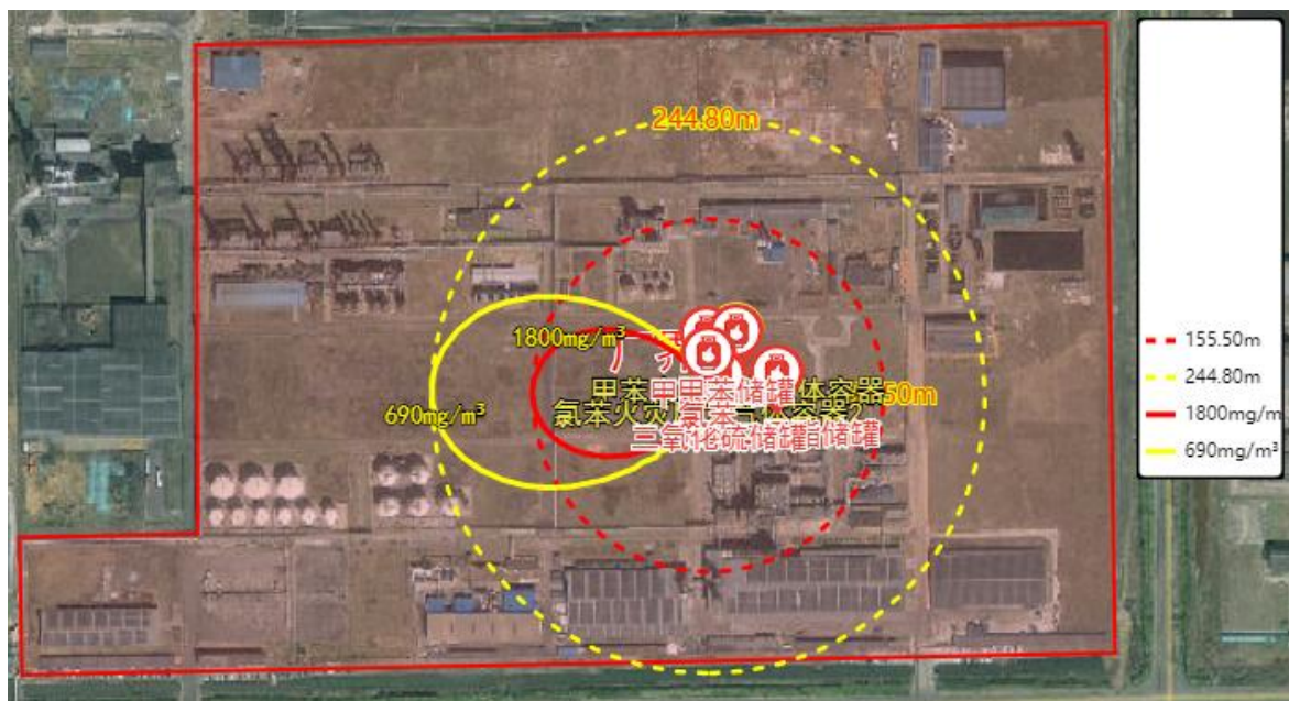
图 5.9-11 氯苯泄漏污染事故最不利气象影响区域图（黄色线：终点浓度 2；红色线：终点浓度 1）
