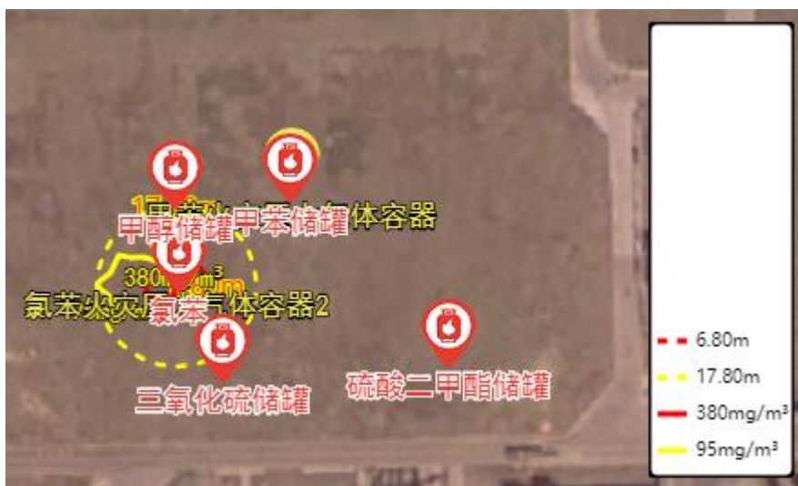
图 5.9-23 氯苯火灾次生污染一氧化碳事故最不利气象影响区域图（黄色线：终点浓度 2；红色线：终点浓度 1）
