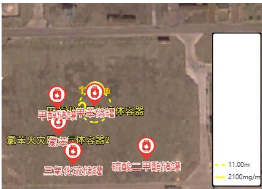
图 5.9-8 甲苯泄漏污染事故最不利气象影响区域图（黄色线：终点浓度 2）
